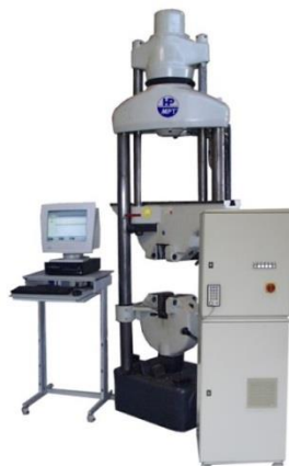
Modernisation MAN 600kN
